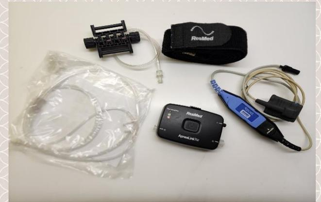
HST设备可以记录高达5个通道的数据：呼吸气力、脉搏率、血氧饱和度、鼻流量和打鼾。
